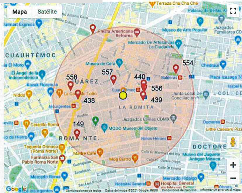
Figura 9. Ubicación de bancos de nivel en un radio de 1 km a partir del sitio de proyecto
